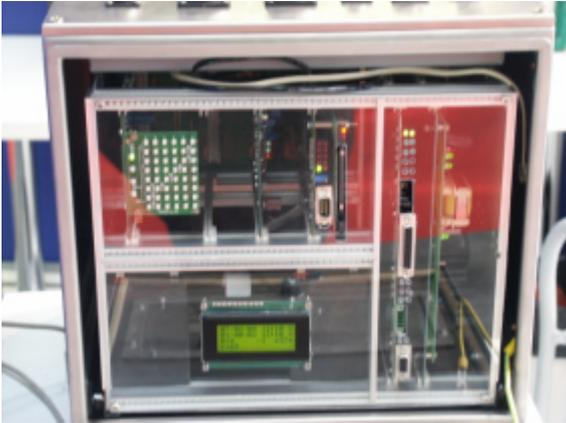
**Penelope** è il nuovo Registratore Cronologico di Eventi della Ora Elettrica S.p.A. ed è una apparecchiatura realizzata in linea con la Specifica Tecnica IS 733 col fine di acquisire e memorizzare la variazione di eventi provenienti dal campo ferroviario.
